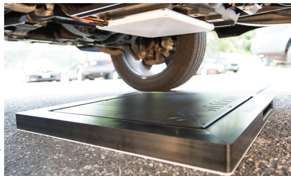
РИС. 2. Слева: резонатор приемника, резонансный повторитель и резонатор источника. В центре: резонатор источника WiTricity для применений, связанных с бытовой электроникой. Справа: Беспроводная зарядка электроавтомобиля, припаркованного над зарядной площадкой.
