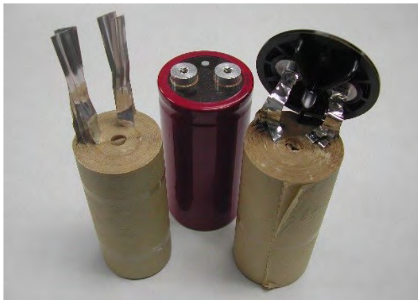
图 20 铝电解电容器由铝箔和具有热学各向异性的纤维素隔膜卷绕组成。
